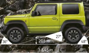
Grosse Böschungswinkel, maximaler Rampenwinkel und viel Bodenfreiheit.
